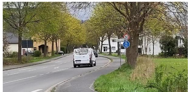
Foto 44: Die Windecker Straße (L333) ist in ihrem aktuellen Zustand für einen Geh-Radweg mit Zweirichtungsverkehr in ausreichender Breite nicht geeignet.
