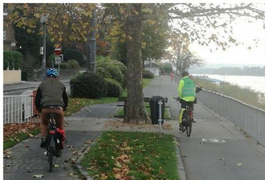
Foto 26: Es muss vermieden werden, dass Fußgängerquerungen des Radwegs ausgerechnet dort sind, wo ein Baum und eine Bank den Raum verengen. Die Fußgängerquerungen sind an geeigneter Stelle so zu gestalten, dass ein sicheres Überqueren des Radwegs möglich ist (gute Sichtbeziehungen, reduzierte Radgeschwindigkeit, Möglichkeit eines Zebrastreifens prüfen).
