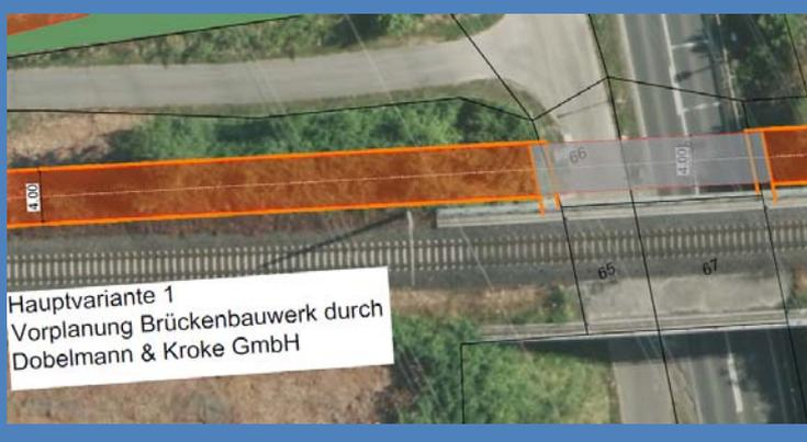
Die sicherste und komfortabelste Führung ist die planfreie Führung z.B. durch Brücken. Zur Querung der K12n (Alfter / Bonn) sowie in einer Planungsvarianten zur Querung der Straße Am Probsthof (Bonn) werden Brückenbauwerke empfohlen.
