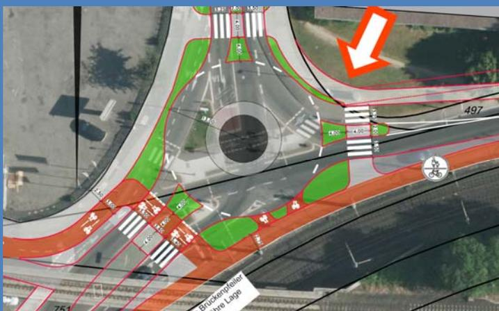
In Bonn wird für die Kreuzung Brühler Straße / Justus-von-Liebig-Straße ein Kreisverkehr vorgeschlagen. Dieser sichert die benötigten Flächen für die RadPendlerRoute und ermöglicht gleichzeitig die sichere Anbindung einer abzweigenden Hauptverbindung nach Tannenbusch.
