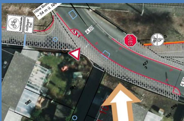
An Querungsstellen, an denen der Radverkehr aus unterschiedlichen Gründen nicht bevorrechtigt werden kann / sollte, ist auf die Herstellung eines kurzen Querungswegs (Seitenraumvorziehung) sowie sehr gute Sichtbeziehungen zu achten. Für die hier dargestellte Querung Siefenfeldchen ist aufgrund der Geometrie des Brückenbauwerks die Sicht gesondert zu prüfen und ggf. Z. 206 (STOP) zu montieren.
