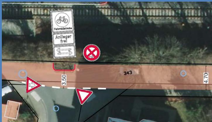
Die Bevorrechtigung entlang von Fahrradstraßen durch vorfahrtregelnde Verkehrszeichen (Z. 301 / Z. 205) und Markierungen ist außerhalb von Tempo-30 Zonen ein einfaches und kostengünstiges Element zur Beschleunigung des Radverkehrs entlang der RadPendlerRoute.
