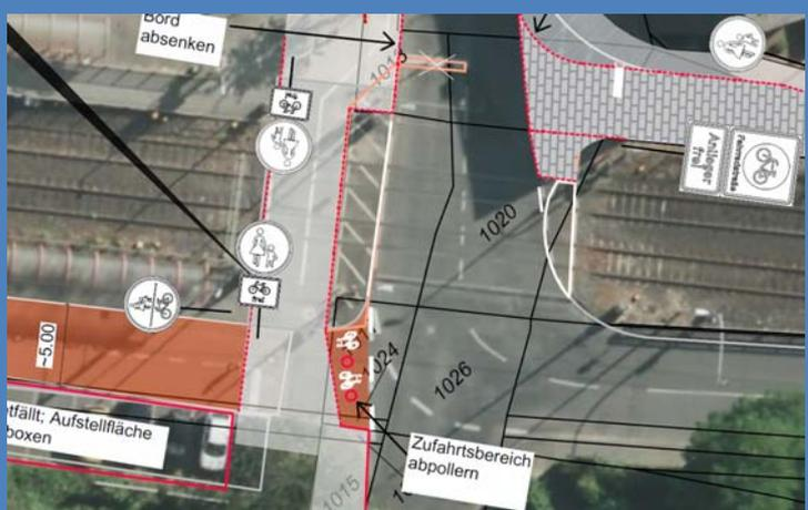
An drei Querungsstellen, an denen unmittelbar parallel die Trasse der Stadtbahn verläuft, wird der Radverkehr untergeordnet bleiben. Hier ist daher dafür Sorge zu tragen, dass sichere Aufstellmöglichkeiten und optimale Sichtbedingungen für den Radverkehr geschaffen werden.
