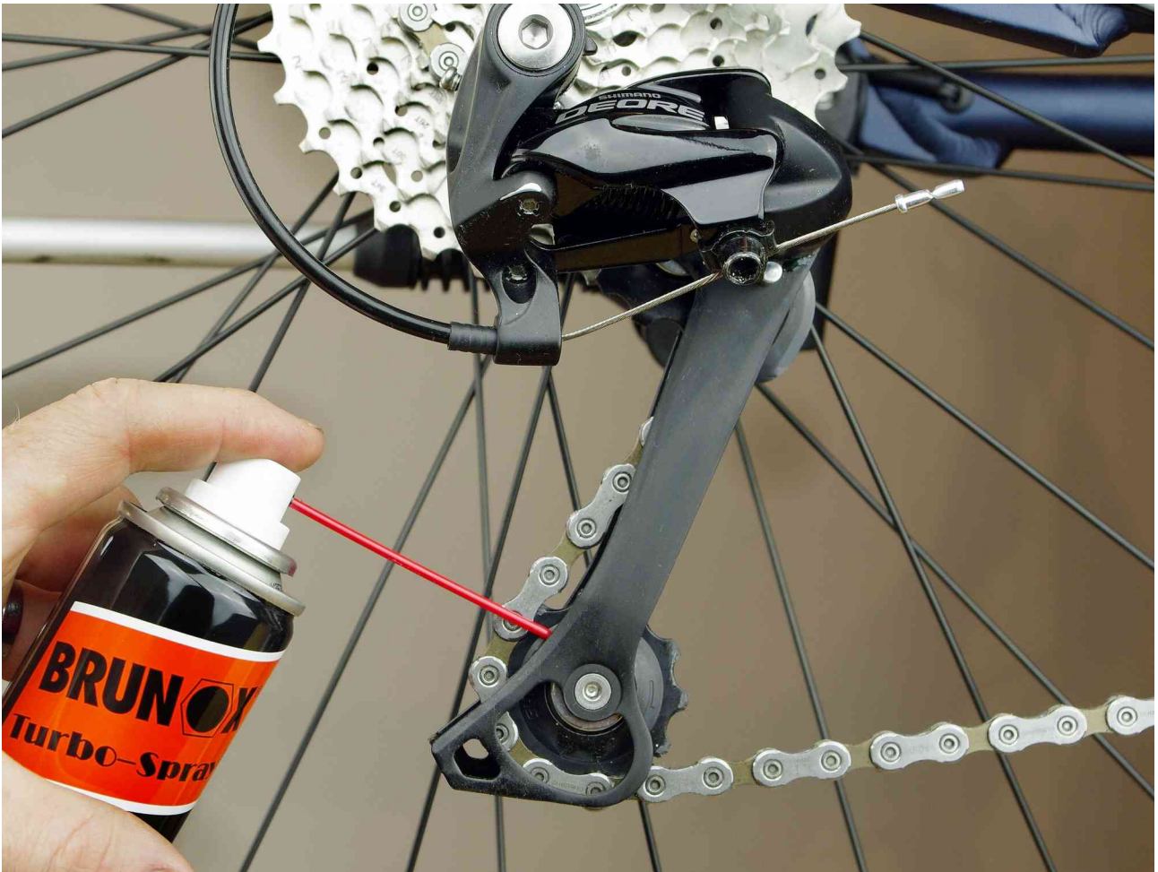
Etwas Multiöl an beide Lager der Schaltwerkrollen oben und unten
