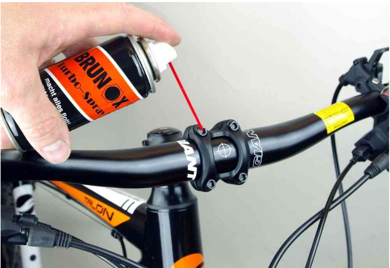
Rostige Schrauben an Lenker, Vorbau, Sattelstütze und Anbauteilen, wie Gepäckträger und Schutzblechen, dürfen ebenfalls mit 1-2 Tropfen Multiöl konserviert werden
