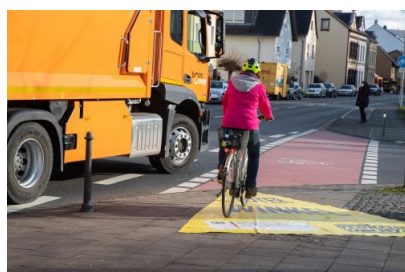
Die schwarze Box direkt an der zweiten Achse ist der Abbiegeassistent. © bonnorange
